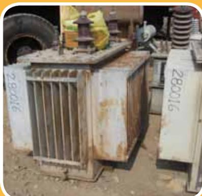
Los transformadores contaminados con PCB con frecuencia se pueden identificar por el tipo o marca de fluido dieléctrico que contiene, denominados en forma general como Askarel.
